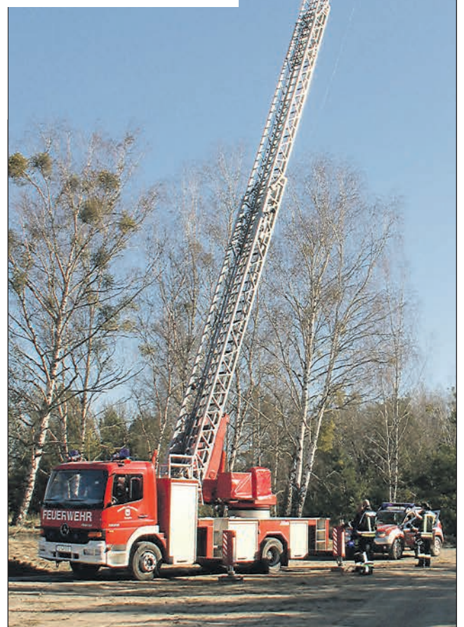
Die 30 Meter hohe Drehleiter diente als Antennenmast um den Funkbetrieb zwischen den Wehren in der Tangersdorfer Heide zu sichern.
