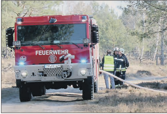
Zum Einsatz kam auch ein nagelneuer Tatra-Tanker, er ist speziell für die Waldbrandbekämpfung gebaut worden, kann 9000 Liter Wasser aufnehmen. Fotos: DM
