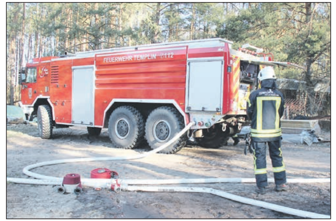
Zum Einsatz kam auch ein nagelneuer Tatra-Tanker, er ist speziell für die Waldbrandbekämpfung gebaut worden, kann 9000 Liter Wasser aufnehmen. Fotos: DM
