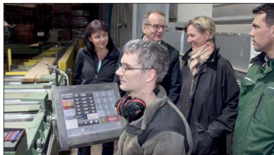
In der Vermessung wird das Schnittholz einzeln qualitativ bewertet. Etwa 1300 Bohlen werden pro Schicht so begutachtet.
